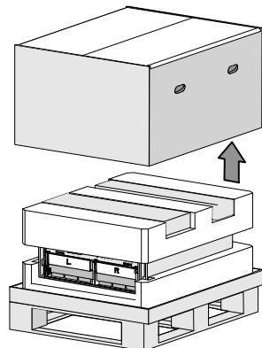
**3** 取下卡进顶部泡沫聚苯乙烯材料段中两个凹槽内的附件盒。
