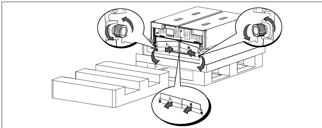
**7** 确保所有电池接头都已断开连接。
