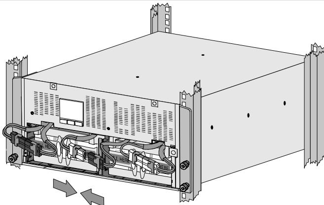
**10** 连接内部电池连接器：
