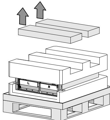
**5** 将顶部的泡沫聚苯乙烯部分取下, 放在附近平整、平稳的平面上。
