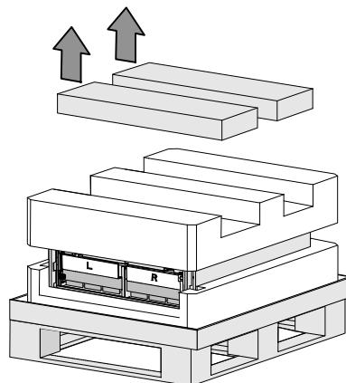
**5** Retire la sección superior de Styrofoam y colóquela cerca en una superficie plana y estable.
