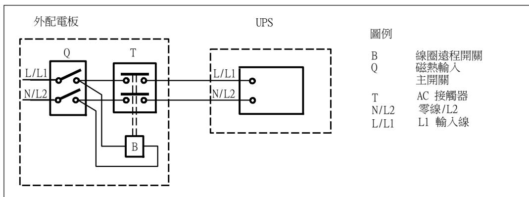
下表列出可用作外部隔離設備以進行反向饋電保護的反向饋電保護設備（AC 接觸器）。
