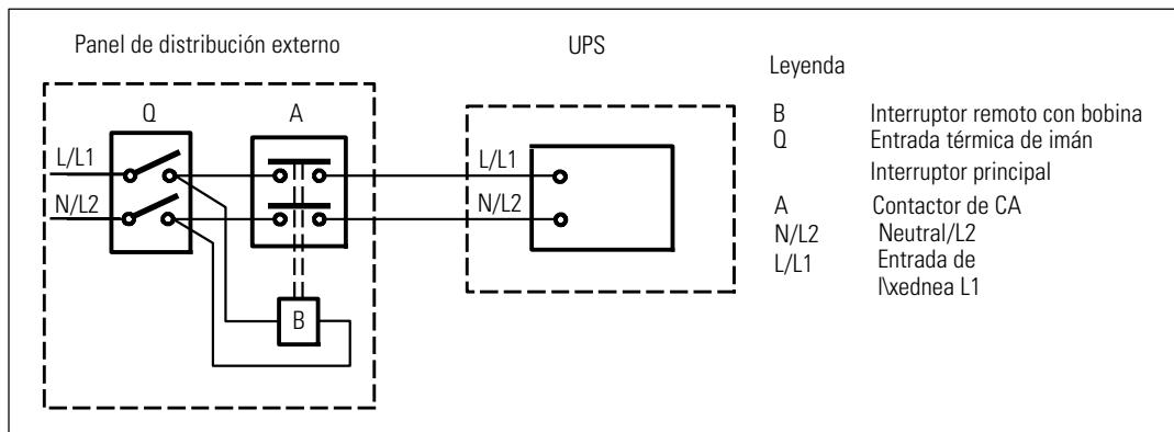
La siguiente tabla enumera los dispositivos de protección de retroalimentación (conectores de AC) que se pueden utilizar como dispositivo de aislamiento externo para la protección de retroalimentación. Utilice solo los contactores de CA enumerados en la tabla.
