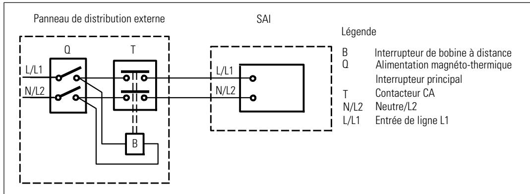
Le tableau ci-dessous énumère les dispositifs de protection contre les renvois de tension (contacteurs CA) qui peuvent être utilisés comme un dispositif isolant externe de protection contre les renvois de tension. Utilisez uniquement les contacteurs CA énumérés dans le tableau.
