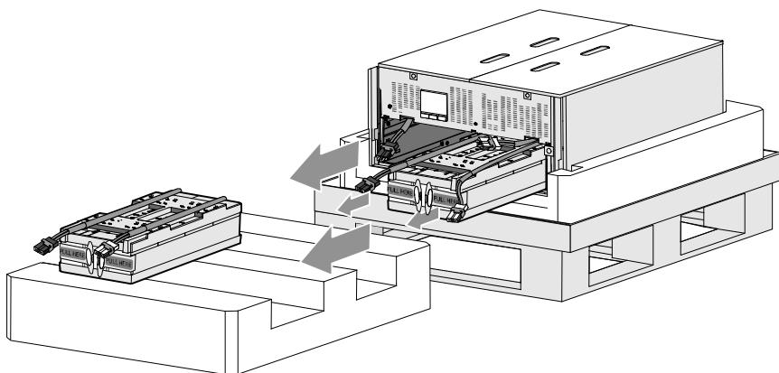
**!** **ВНИМАНИЕ!** Корпус тяжелый (46 кг/101 фунт), даже если батареи сняты. Для извлечения корпуса из картонного поддона для транспортировки требуется не менее двух человек.
