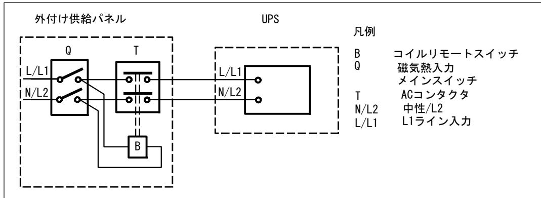
以下のリストは、負帰還を防ぐための外付けの絶縁装置として利用可能な負帰還保護装置(ACコンタクタ)を一覧表示しています。
