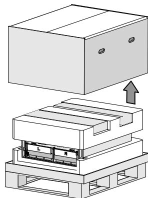
**3** Retire las dos cajas con accesorios que se encuentran dentro de los canales en la sección superior de Styrofoam.
