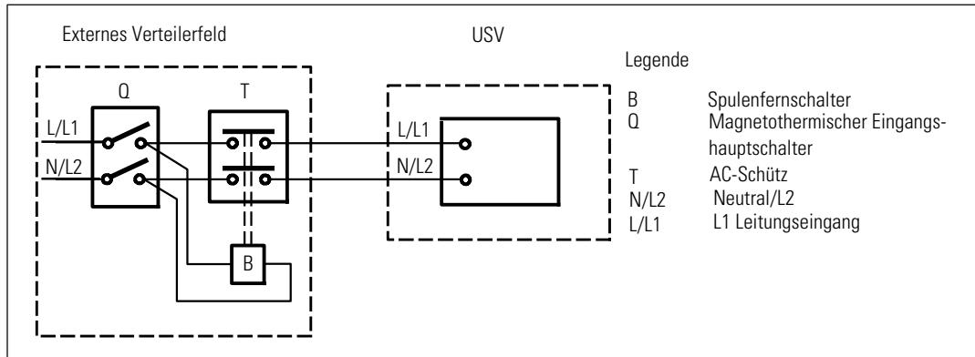
Die folgende Tabelle listet die Rückkopplungsschutzgeräte (AC-Schütze) auf, die als externe Isolationsgeräte zum Rückkopplungsschutz verwendet werden können. Verwenden Sie nur die in der Tabelle aufgeführten AC-Schütze.
