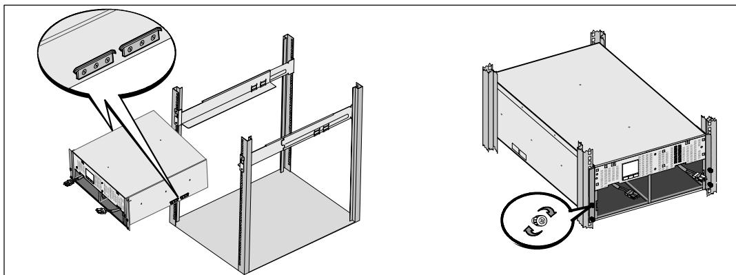
**! ACHTUNG: Das Gehäuse ist trotz entfernter Akkus schwer (46 kg). Zum Heben des Gehäuses in das Rack sind mindestens zwei Personen erforderlich.**
