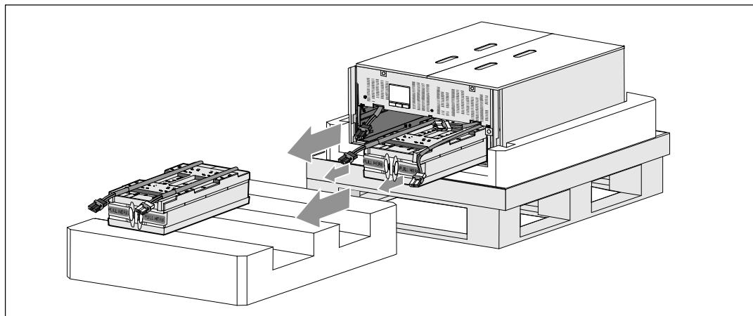
**!** **ACHTUNG:** Das Gehäuse ist trotz entfernter Akkus schwer (46 kg). Zum Heben des Gehäuses aus dem Versandkarton sind mindestens zwei Personen erforderlich.
