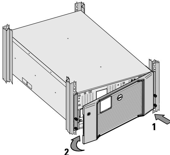
**13** Установите переднюю крышку ИБП:
