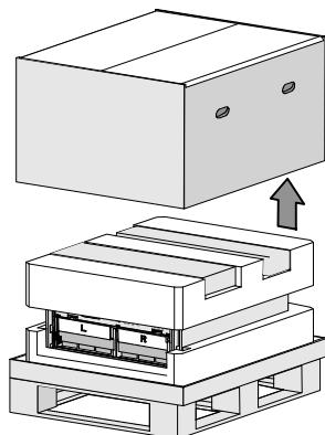
**3** Выньте два ящика с принадлежностями, находящиеся в рельефных каналах в верхней части пенопласта.
