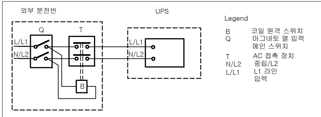
다음 표는 역류(backfeed)를 차단하는 외부 차단 장치로 사용할 수 있는 역류(backfeed) 방지 장치(AC 접촉장치)의 목록입니다. 테이블에 나열된 AC 접촉 장치만을 사용하십시오.
