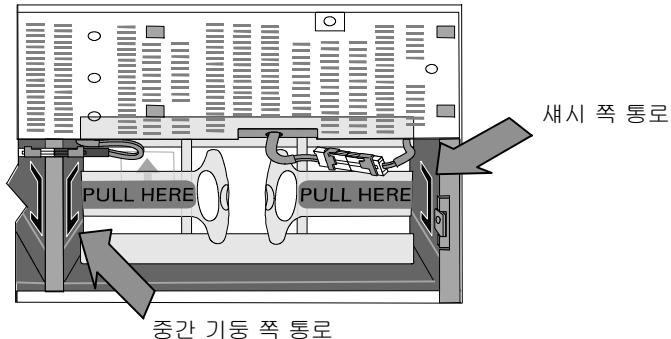
**참고:** 배터리 지지 브래킷에는 L(왼쪽) 및 R(오른쪽)이 표시가 되어 있어 설치 위치를 알려줍니다.
