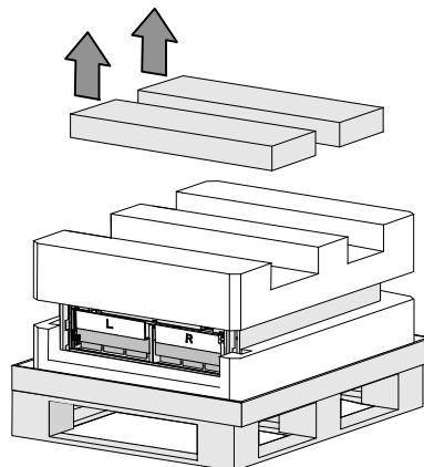
**5** 將頂部的泡沫聚苯乙烯部分取下，放在附近平整、平穩的平面上。
