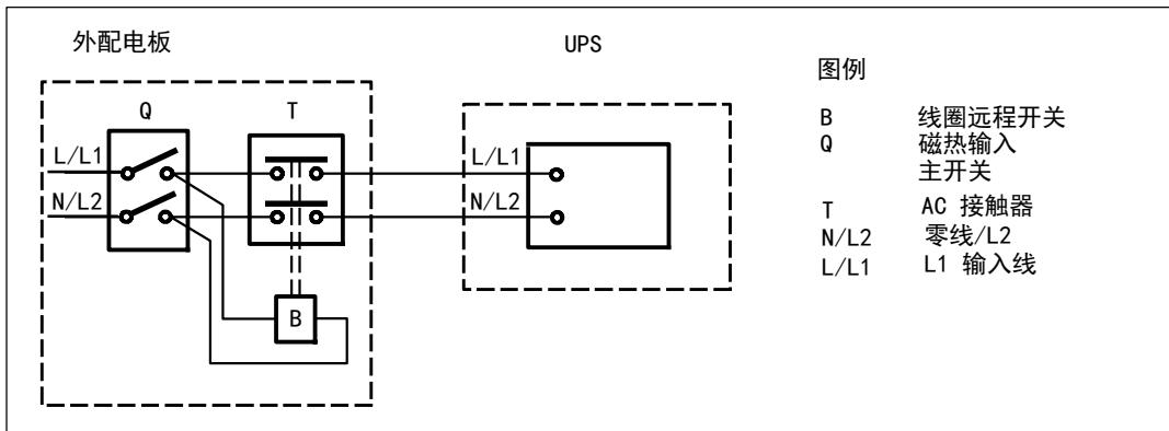
下表列出可用作外部隔离设备以进行反向馈电保护的反向馈电保护设备（AC 接触器）。仅使用表中列出的 AC 接触器。
