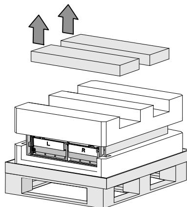
**5** Снимите верхнюю часть пенопласта и установите его на ровную устойчивую поверхность неподалеку.
