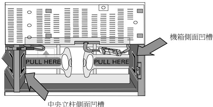
**注意：** 電池固定支架上帶有左右側標記 **L**（左）和 **R**（右），透過此種方式標示出了安裝時它們必須位於的位置。
